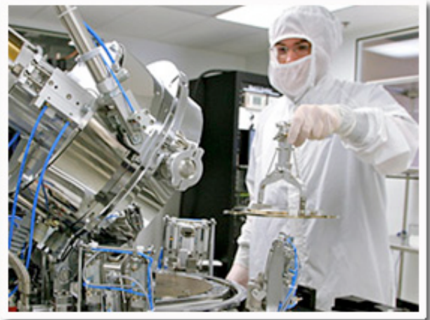
Les scientifiques du CNRC font appel à une gaufreuse à chaud (photo) de nanolithographie de pointe pour élaborer de nouvelles technologies de détection des risques de contamination biologique et de diagnostic médical.
