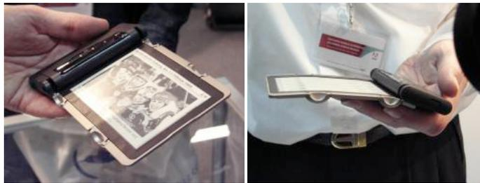
Cela lui permet, lorsqu'il est fermÃ©, de possÃ©der des dimensions comparables Ã  celles de mobiles classiques : 115 x 57 x 21 mm pour 115 g ) tout en Ã©tant capable de dÃ©voiler un **large Ã©cran 5" non tactile et en 16 niveaux de gris**.
